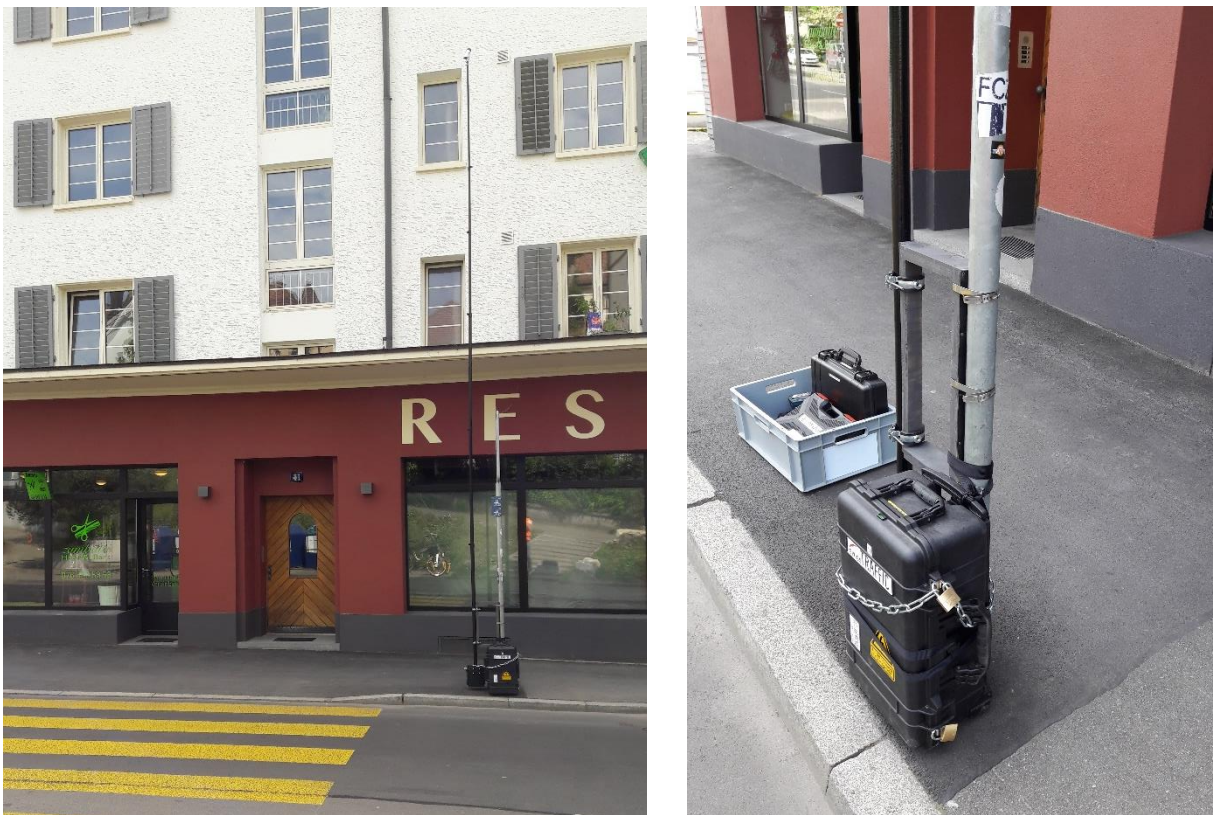
Abbildung 1 Testinstallation der Kamera in der Höggerstrasse; Gesamtansicht (links) und Anordnung des Steuergeräts am Boden (rechts)
